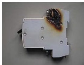
Abbildung 20: Defekter LSS Während des Betriebes von elektrischen Anlagen kann es aus verschiedensten Gründen zum Auftreten von Störungen innerhalb oder außerhalb der Anlage kommen. Die Gründe hierfür können z.B. defekte Bauteile wie NH-Sicherungen, RCD, MCB, ÜSS oder auch defekte bzw. fehlerhafte Kabel und Leitungen sein. Auch Beeinträchtigungen der Isolation durch äußere Einflüsse wie Wärme, Feuchtigkeit und Staub führen oftmals bereits nach kurzer Zeit unerwartet zu Gefährdungen. Davon können einzelne Anlagenteile, aber auch leitende Verbindungen betroffen sein. Des Weiteren kann es durch Fremdeinwirkungen wie z.B. Verkehrsunfällen, Naturgewalten, Vandalismus o.ä. zu einer Beschädigung der elektrischen Anlage kommen.
